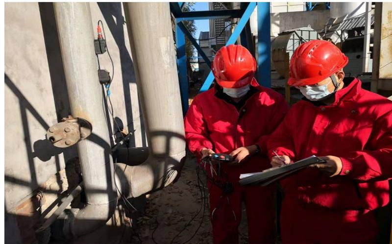
水平衡测试（超声波流量计测试单台设备）
